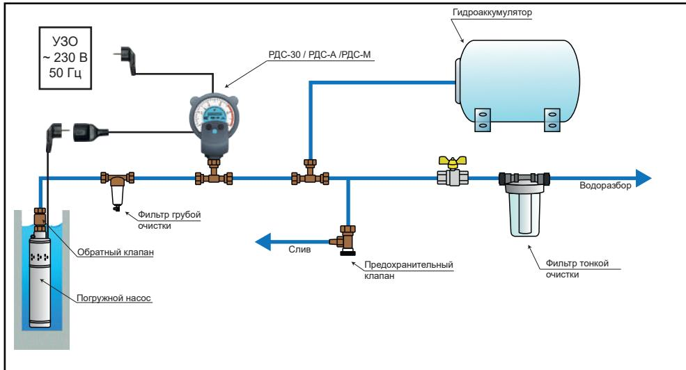
14.2 Пример подключения РДС с поверхностным насосом мощностью Р1 не более 1,5 кВт (ток потребления не более 6,8А)
